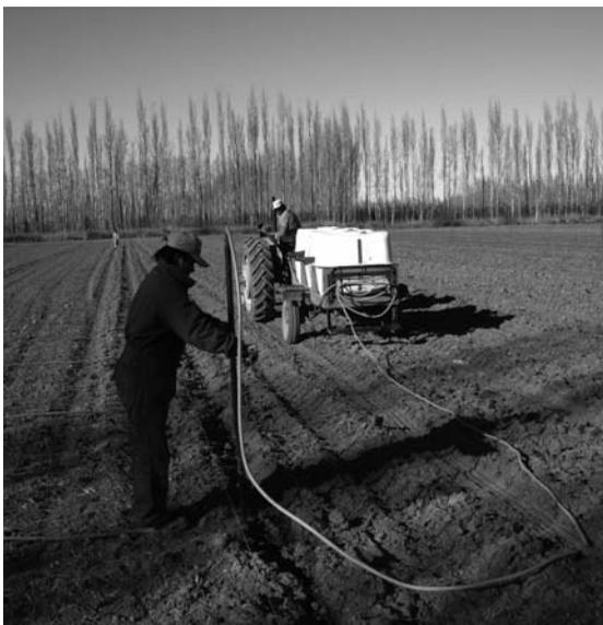
Figura 2. Barreta hidráulica conectada a la pulverizadora a través de una manguera
